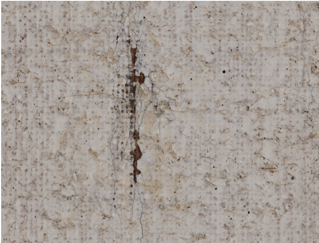
Fig. 10. Detalle de pérdidas asociadas a grietas. Localizada en la mano de la mujer que asoma por la ventana.
