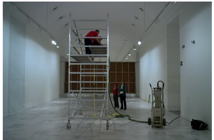
Fig. 24. Instalación de la placa radiográfica sobre el soporte móvil (izquierda) y preparación del equipo de Rayos X con Guernica al fondo de la sala (derecha)
